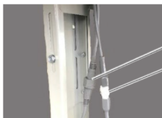
Подключение шнура питания и провода механизма педали
