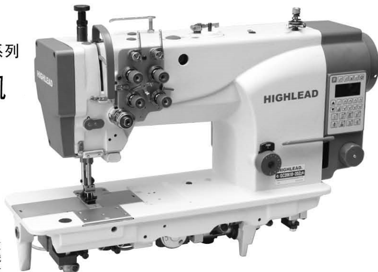
GC20618-2DZA直驱式自动剪线双针综合送料厚料平缝机
